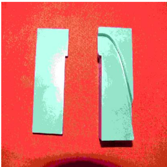
Fig 3: Nozzle (wax) patterns
